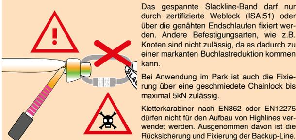
Das gespannte Slackline-Band darf nur durch zertifizierte Weblock (ISA:51) oder über die genähten Endschlaufen fixiert werden. Andere Befestigungsarten, wie z.B. Knoten sind nicht zulässig, da es dadurch zu einer markanten Buchlastreduktion kommen kann.
